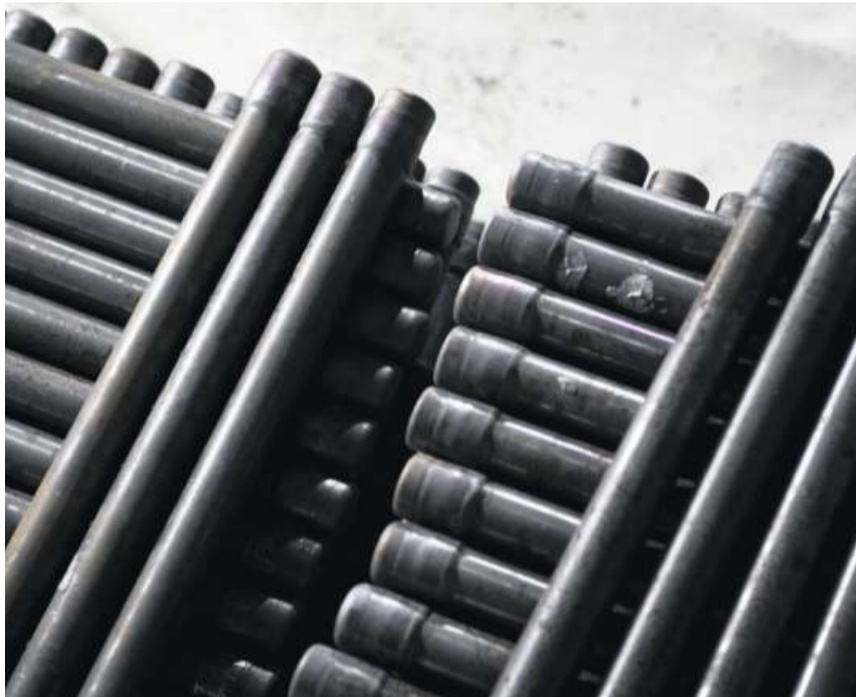
Im Wärmespeicher sind mit Metall gefüllte Stahlrohre gestapelt. KARIN HOFER
